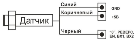
Рис.5. Пример подключения датчика SM (NPN).
