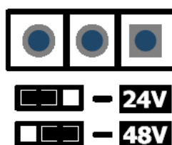
Рис. 10. Переключатель установки включения тормозной схемы.
