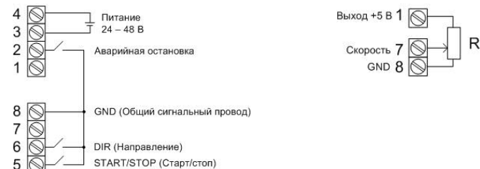
Рис. 3. Подключение питания и внешних цепей управления
