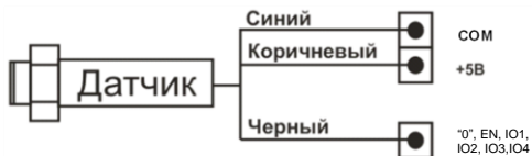
Рис. 10. Пример подключения концевого датчика к блоку.
