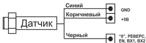
Рис. 5. Пример подключения датчика SM (NPN).
