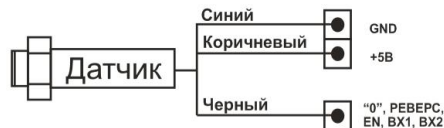
Рис. 5. Пример подключения датчика SM (NPN).
