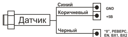
Рис. 5. Пример подключения датчика SM (NPN).
