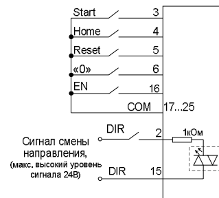
Рис. 6. Пример подключения блока в режиме контроллера
