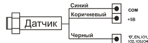
Рис. 9. Пример подключения концевое датчика к блоку.
