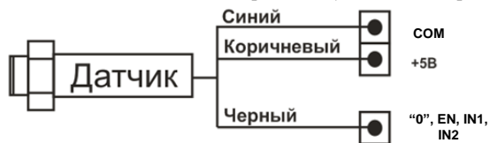
Рис.6. Пример схемы подключения концевого датчика к блоку SMSD-4.2
