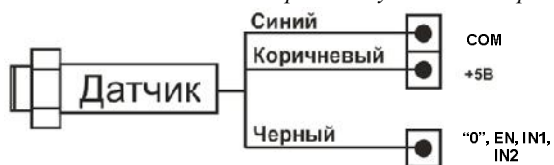
Рис.6. Пример схемы подключения концевого датчика к блоку SMSD-4.2
